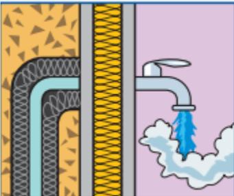
**Aislamiento de las instalaciones (tuberías)** instalando un material aislante térmico en las tuberías de conducción del agua caliente o fría, de las calderas, de los acumuladores de calor, etc... de los edificios, para evitar pérdidas de calor en el transporte del agua caliente y evitar posibles condensaciones en las conducciones de agua fría.
